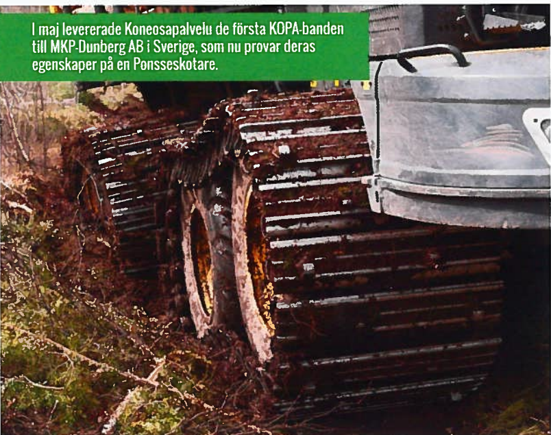
Kunderna har även provat KOPA-banden vintertid och berättat att de packar snön så att den blir bärande under skogsmaskinen
