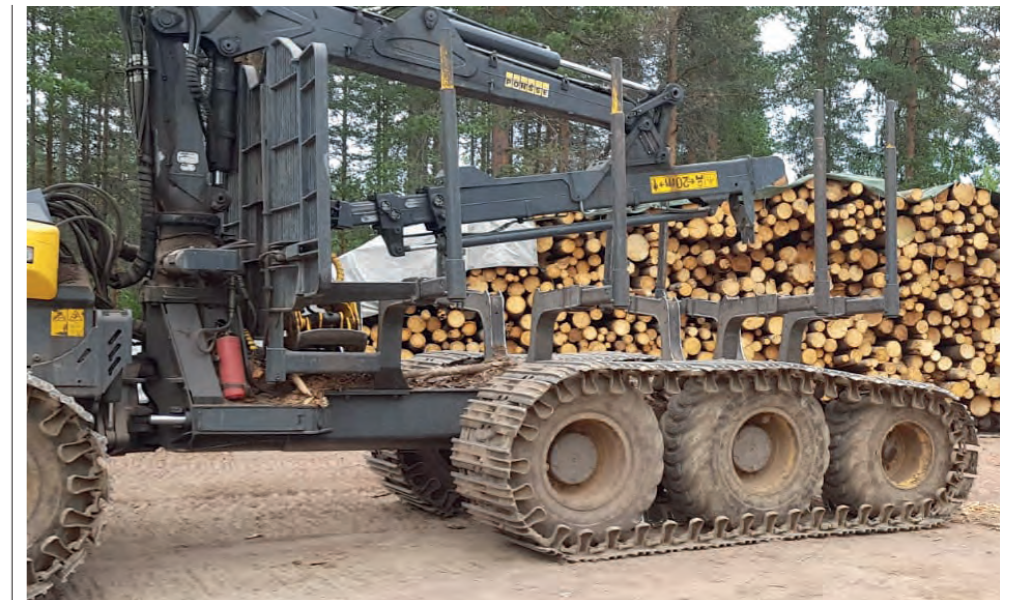
KOPA-telat ovat osoittautuneet toimiviksi 10-pyöräisessä Ponsse Wisent kuormatraktoreissa. KOPA-telat ovat 1000 mm leveät ja takatelillä telamatto metriä pidempi kuin normaalisti, joten kantavuus on omaa luokkaansa.
