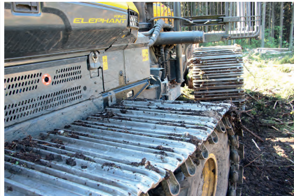
Veljekset Lehtomäellä on hyviä kokemuksia KOPA-teloista myös järeissä Ponsse Elephant King kuormatraktoreissa kolmen vuoden ajalta; telaleveys on sekä edessä että takana 1000 mm.
